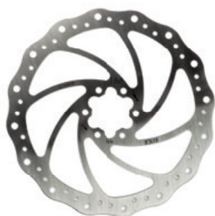
SX18 ROTOR 180 MM Bremsscheibe 6-Loch Edelstahl, 151 g, silber Art.-Nr. 320112 empf. VK: 19,95 €
